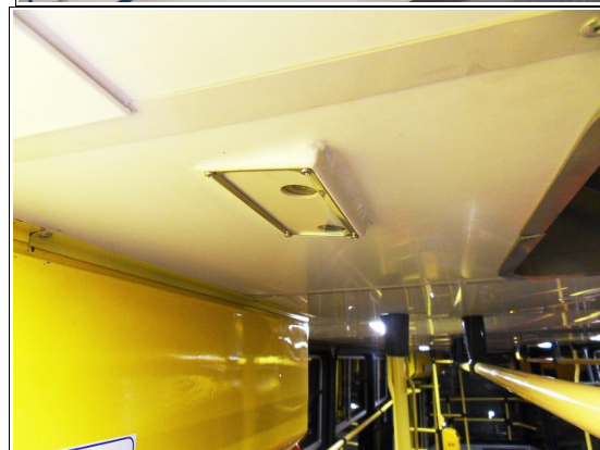
Moduł liczący zainstalowany w niskopodłogowym autobusie (u góry) i w tramwaju starszego typu (na dole).
